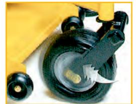
Suspensions Flex-Forks<sup>™</sup> sur roues avant
