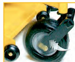
Suspensions Flex-Forks™ sur roues avant
