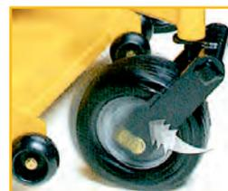
Suspensions Flex-Forks™ sur roues avant
