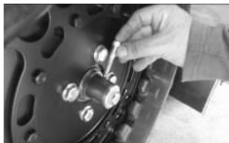
Fig. 15 utiliser le nouveau scellé pour retirer le scellé cassé en s'aidant éventuellement d'un marteau
