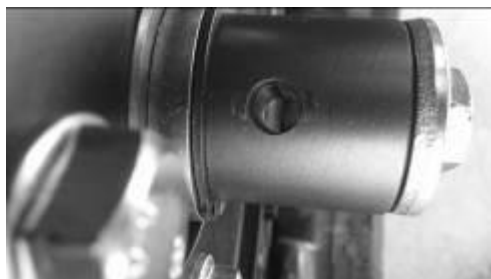
Fig. 14 Aligner le trou du cylindre externe avec le trou de l'arbre interne contenant le scellé cassé
