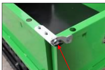
Figure 4 – Réglage des rebords
