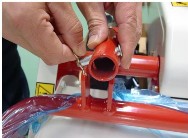
29) Fixez le support de roues avant sur le système de réglage de la hauteur de coupe, comme indiqué sur la photo.
