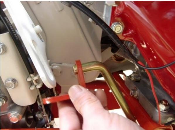
17) Insérer l'extrémité du levier de vitesse dans le bas de la pâte de fixation
