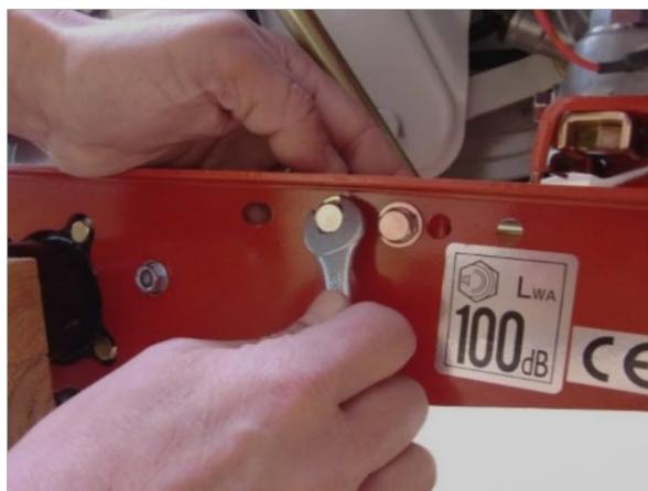
21) Fixez le guide le sélecteur du levier de vitesse et le support arrière avec un boulon.
