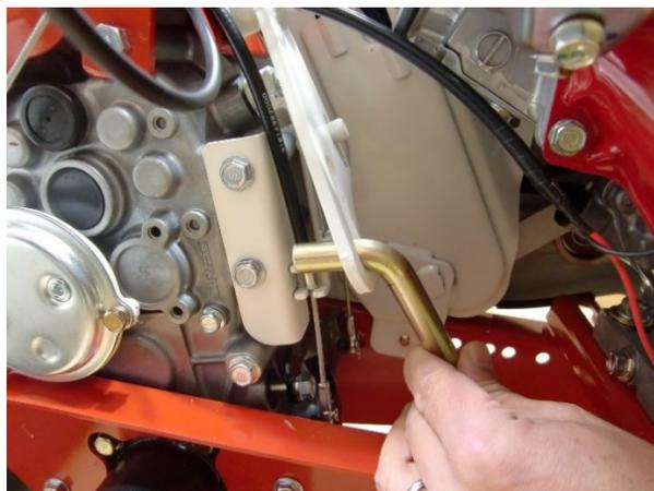
18) Installez la fixation du levier de vitesse sur le châssis à l'aide du boulon, des rondelles et de l'écrou.
