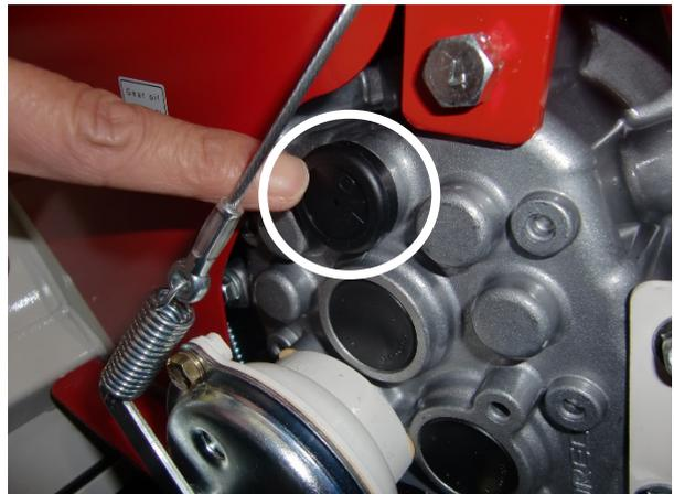
44) Il n'y a pas d'huile dans la transmission lorsque la machine est livrée.
