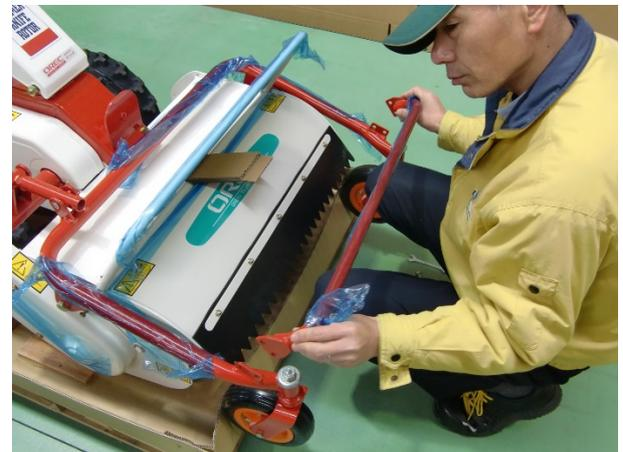
33) Remettre les 4 vis et écrous à leur position d'origine.
