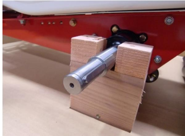
35) Pour monter le pneu arrière, soulevez la partie arrière de la machine en toute sécurité.
