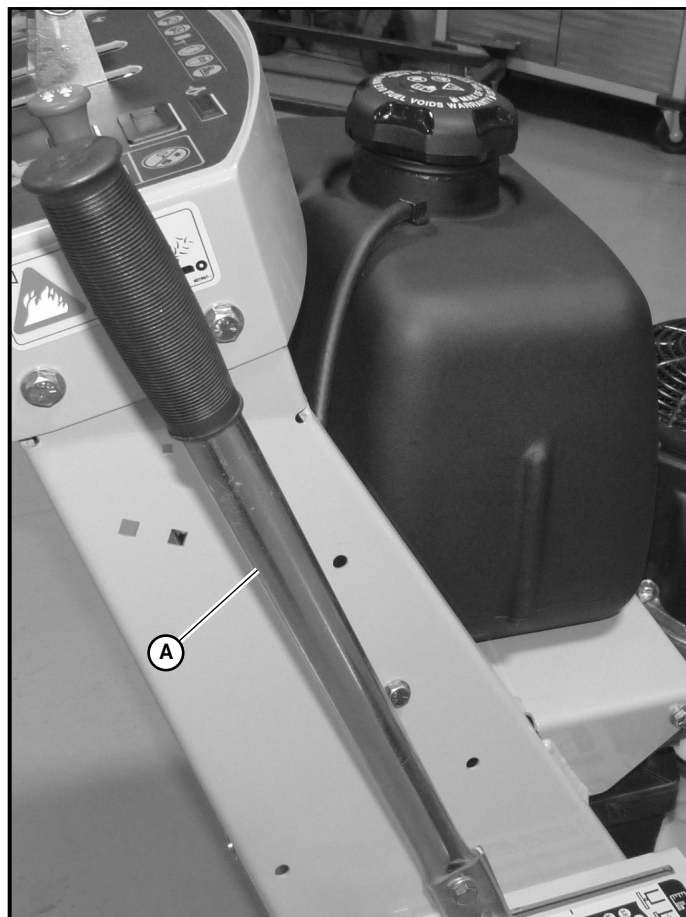
A. Levier d'élévation du plateau de coupe en position de transport
